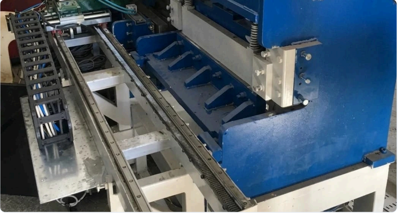
Transfer pres atölyede — 2 eksenli lineer robot rayı, kablo zinciri ve hidrolik pres gövdesi
