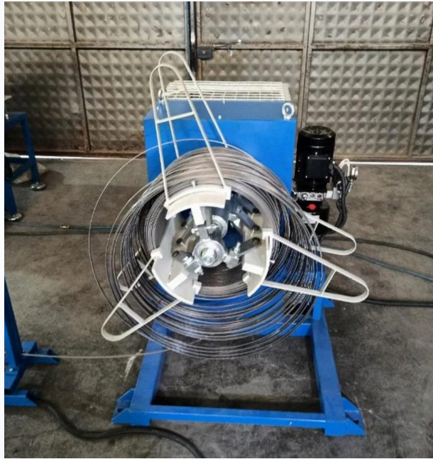
Hidrolik mandrelli rulo açıcı, kumanda panosu ile
