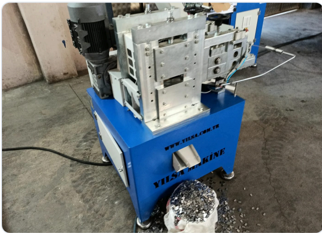
YILSA logolu Rotary Punch doğrama ve markalama makinesi — motor ve çift tamburlu kalıp bloğu
