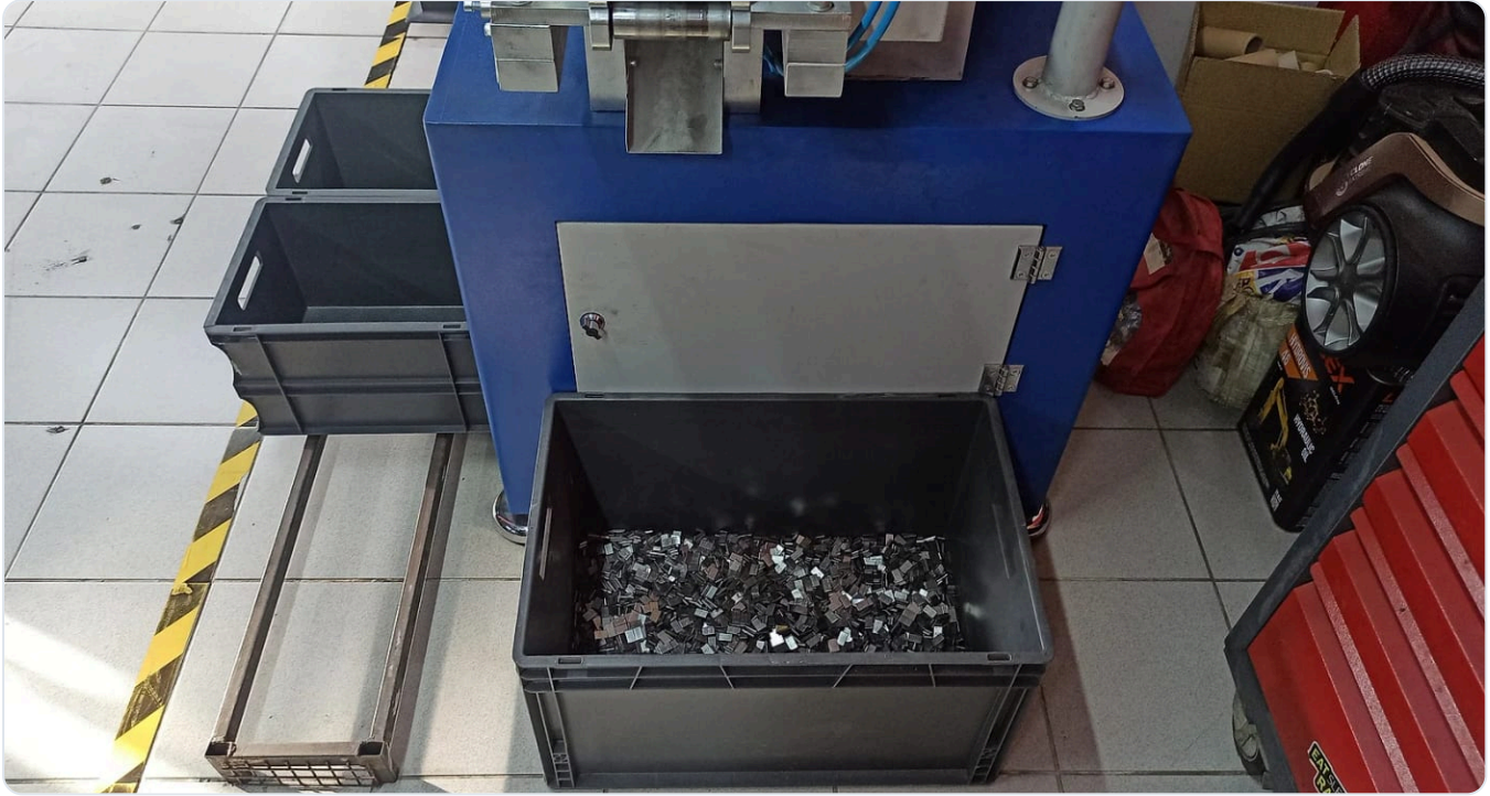
Rotary Punch doğrama ve markalama makinesinden çıkan balans ağırlıkları kasada
