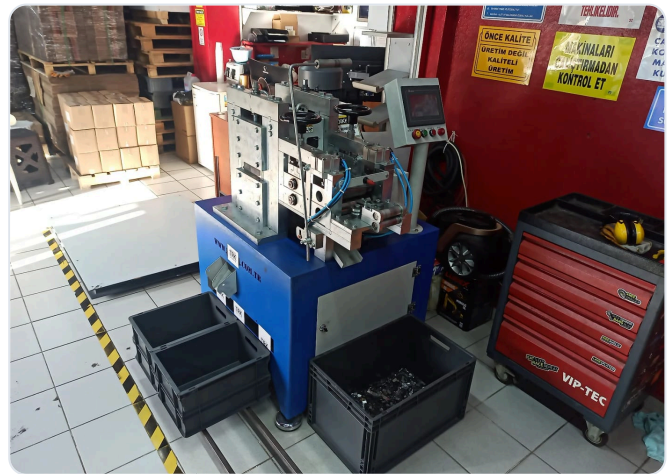
Üretim tesisinde kurulu Rotary Punch doğrama ve markalama makinesi, HMI panel ve ürün kasaları
