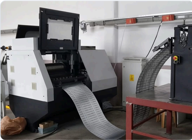
Atölyede çalışan Rotary Punch delme ünitesi, çıkan perfore sac ve doğrultma ünitesi
