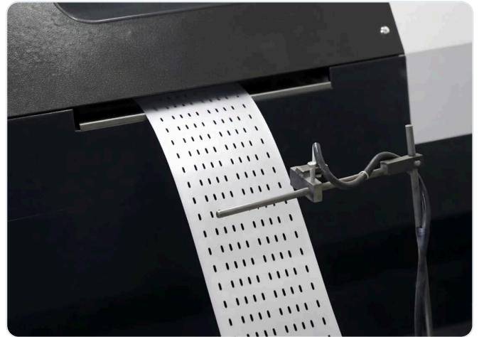
Rotary Punch ile delinmiş oval delikli sacın makineden çıkışı, yakın plan
