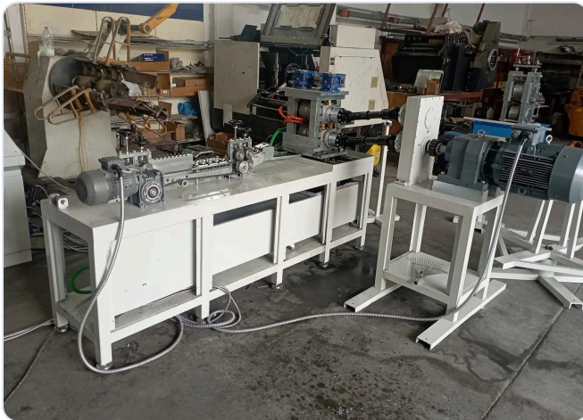
Filmaşın tel ezme makinesi atölyede — tel doğrultma girişi, ezme tamburları ve tahrik motoru
