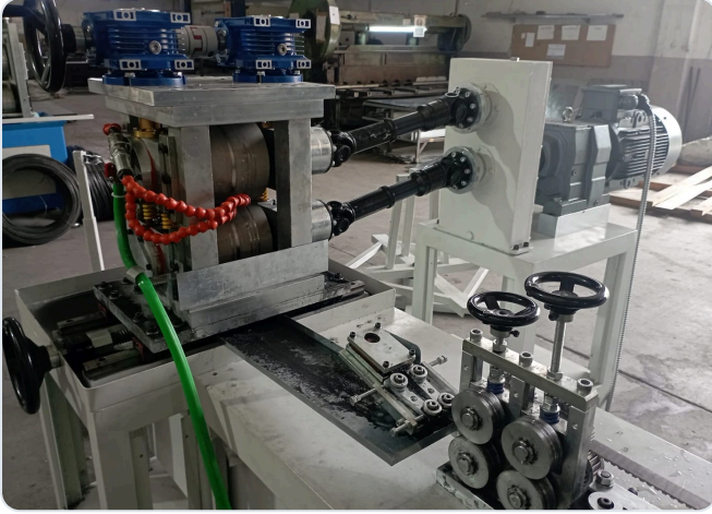
Tel ezme tamburları, merkezi sıkma volanları ve soğutma sıvısı hortumu yakın plan
