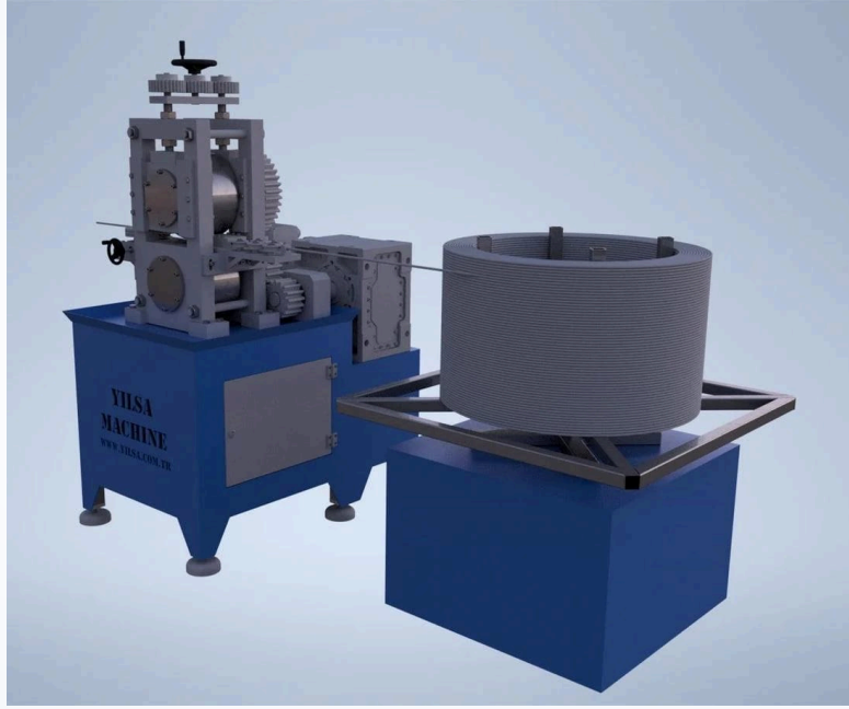
Rulo sarma sistemli tel ezme makinesi (temsili tasarım)
