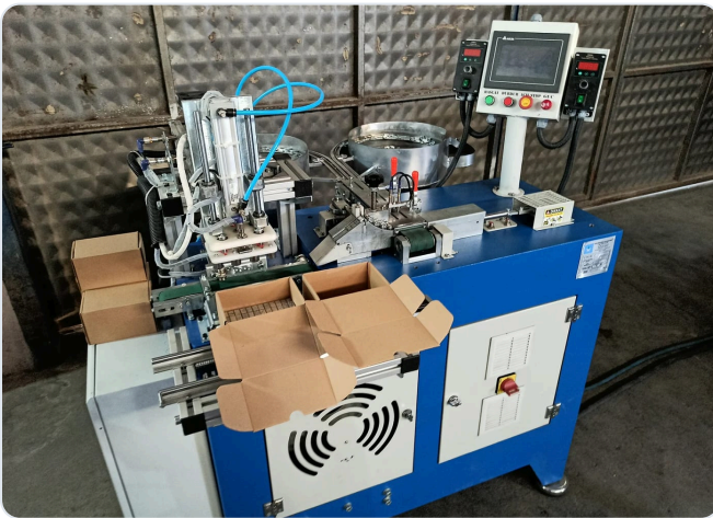
Titreşimli besleyicili bantlama ve paketleme makinesi, kutu dolum istasyonu
