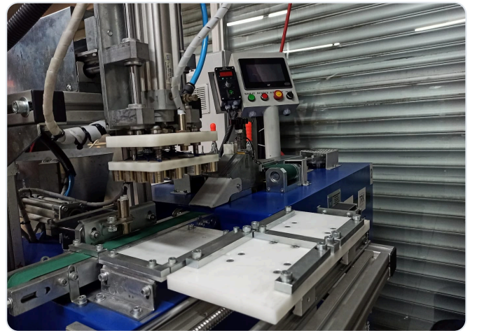
Bantlama ve paketleme makinesinin pnömatik dizme kafası ve paketleme tablası yakın plan
