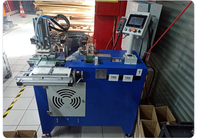
Üretim tesisinde kurulu bantlama ve paketleme makinesi, HMI panel ile
