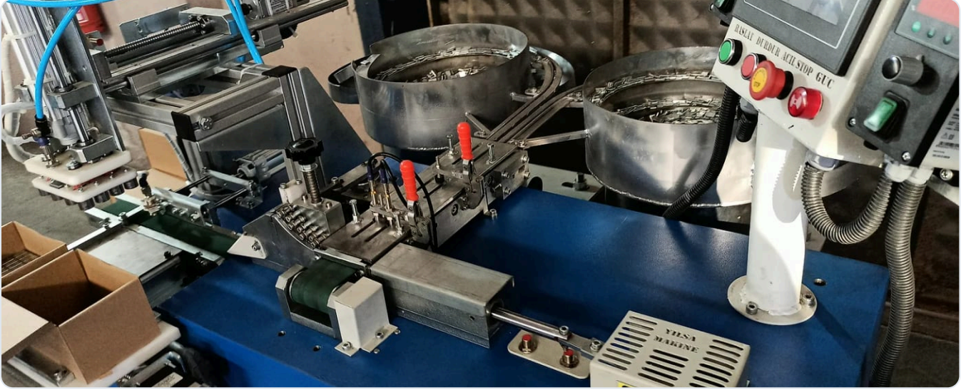
Titreşimli besleyiciler, dizme hattı ve kumanda paneli
