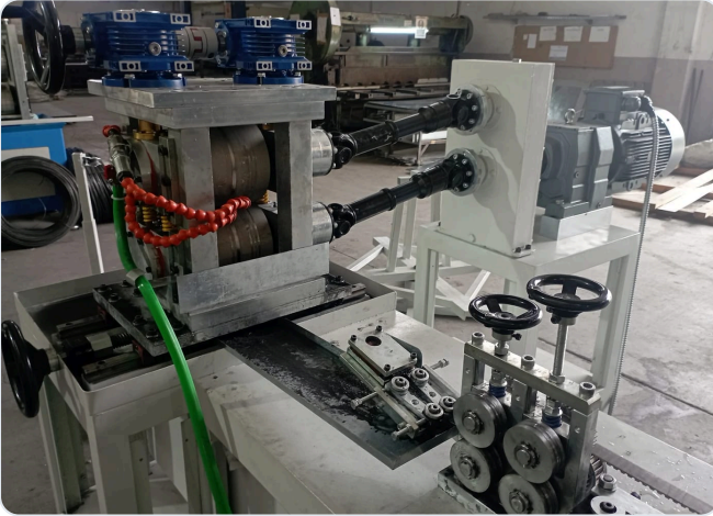
Tel ezme tamburları, merkezi sıkma volanları ve soğutma sıvısı hortumu yakın plan
