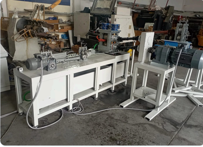
Filmaşın tel ezme makinesi atölyede — tel doğrultma girişi, ezme tamburları ve tahrik motoru
