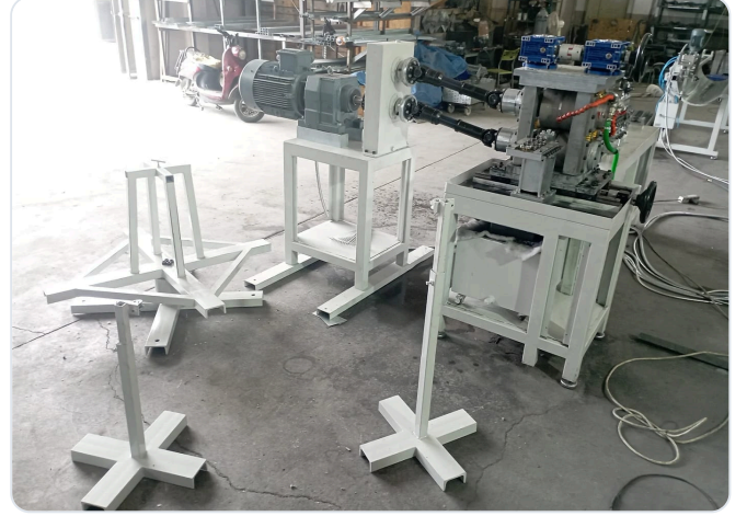
Filmaşın tel ezme makinesi — ezme ünitesi, redüktörlü tahrik ve tel yönlendirme sehpaları
